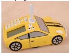
Ce robot fonctionne sur le même principe mais s'adresse à des élèves plus âgés. En effet le clavier utilise des nombres et permet une programmation plus complexe utilisant notamment la notion de répétition d'une séquence et les procédures. Le Pro-bot se programme en Logo. Un écran intégré de 16 lignes permet de relire le programme en mémoire, ce qui fait malheureusement défaut à Bee-Bot. Les instructions sont affichées à l'écran et peuvent être modifiées directement.
