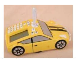
Ce robot fonctionne sur le même principe mais s'adresse à des élèves plus âgés. En effet, le clavier utilise des nombres et permet une programmation plus complexe utilisant notamment la notion de répétition d'une séquence et les procédures. Le Probot se programme en Logo.
