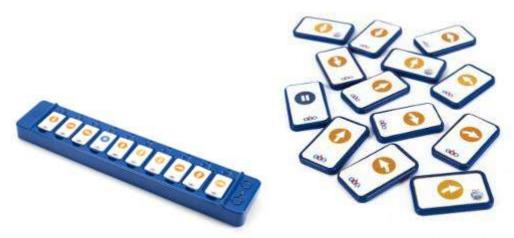
L'élève dispose, de la gauche vers la droite, sur la réglette, des cartes-instructions correspondant au programme qu'il souhaite faire exécuter au robot Blue-Bot. Il ya des cartes de type « Avance d'un pas », « Recule d'un pas », « Pivote à droite », « Pivote à gauche ». On insère les cartes (10 au maximum) dans le clavier de commande puis en appuyant sur le bouton situé à droite du clavier (GO), on envoie les instructions correspondantes au robot, qui alors les exécute.
