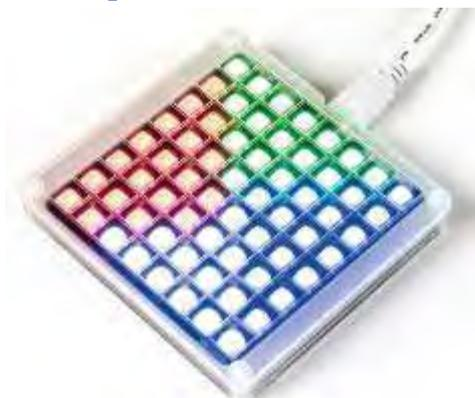
Le Rainbow Matrix de TTSn'est pas à proprement parlé un robot mais plutôt est un objet connecté programmable avec le langage Scratch. Il consiste en une matrice de 64 leds (8x8) pouvant s'allumer, s'éteindre, prendre différentes couleurs, en fonction du codage informatique que l'élève aura réalisé. Ici ce n'est pas l'objet qui bouge, à l'instar d'un robot, c'est la matrice qui se modifie. Le mouvement est visuel ; d'où sa place dans ce recueil.
