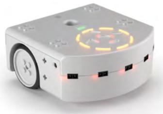
Les « *comportements de base* » intégrés au robot sont accessibles en sélectionnant une couleur à l'aide des « *boutons flèches* », puis en appuyant sur le bouton central pour lancer le robot. Les six « *comportements de base* » sont :
