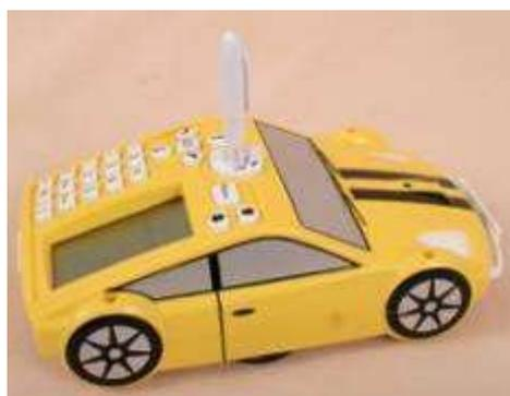
Le robot Pro-Bot fonctionne sur le même principe que le Bee-Bot mais s'adresse à des élèves plus âgés. En effet, le clavier utilise des nombres et permet une programmation plus complexe utilisant notamment la notion de répétition d'une séquence et les procédures. Le Pro-bot se programme en LOGO.
