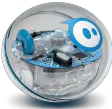
Le robot Sphero SPRK+ est une boule robotique transparente dont la technologie interne est apparente. Pour charger Sphero SPRK+, il faut le placer sur un socle relié au courant par une prise USB. Le mobile va utiliser la charge inductive diffusée par le socle et, une fois chargé pourra fonctionner, de manière autonome, durant une heure.
