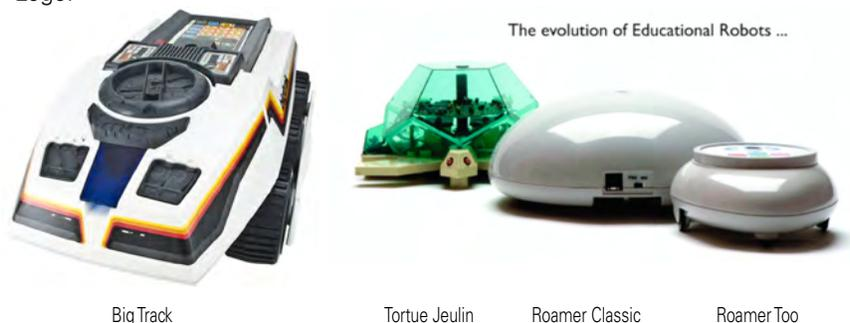
Le principe de ces robots de plancher est que ce sont des outils cybernétiques programmables et que les instructions fournies se traduisent par un mouvement ou un son ou l'allumage d'une lumière.
