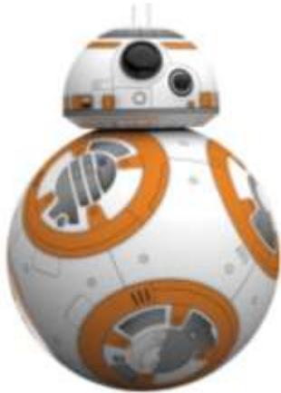
Cette version « Star Wars » de la Sphero a des fonctionnalités légèrement différentes. En effet, sa « tête » permet de programmer des mouvements de hochement de type « oui » ou « non » offrant ainsi de nouvelles possibilités de programmation basées sur les émotions et le dialogue, par exemple.
